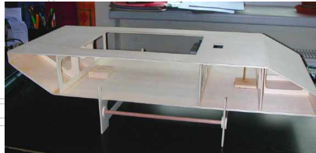
Der Rumpf noch ohne Seitenteile. Gut zu erkennen der Sockel für den Antrieb vorne und der Ruderkoer hinten.
