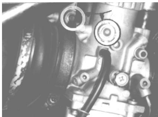
Bild 22.: Schaugläser in den Vergasern
