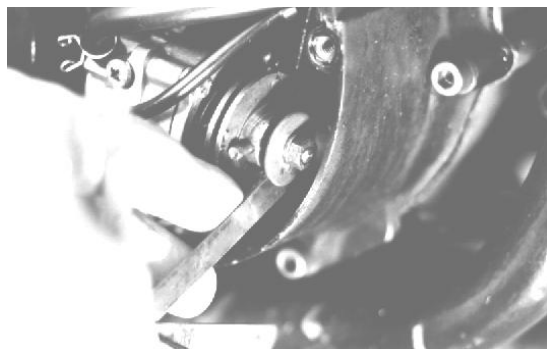
Bild 26.: Messung des Mindestpumpenhubes
