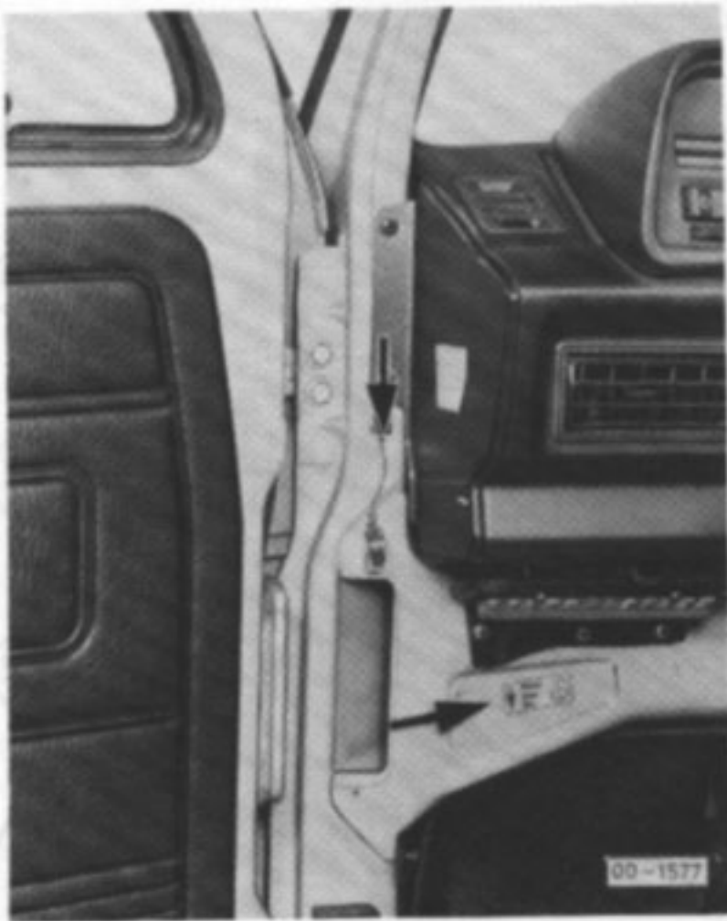
1 Säule I Türkontaktschalter aus- und einbauen.
