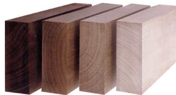
Thermoholz* unterschiedlicher Behandlungsklassen
